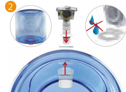
2 Montez le robinet d'eau avec deux joints (secs) à l'intérieur et à l'extérieur du réservoir.
