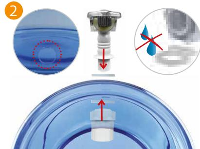
Wasserhahn mit zwei Dichtungen (trocken) jeweils innen und außen am Behälter montieren.
