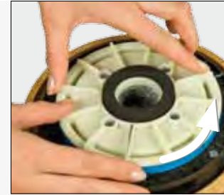
Bild 6 Oberen Stein gegen den Uhrzeigersinn herausdrehen.
